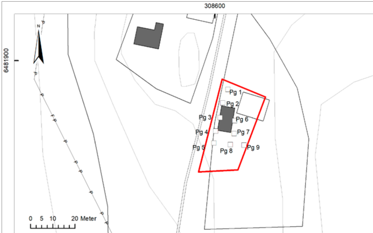
Figur 6. Grävda provgropar schematiskt inlagda utifrån fältanteckningar.
