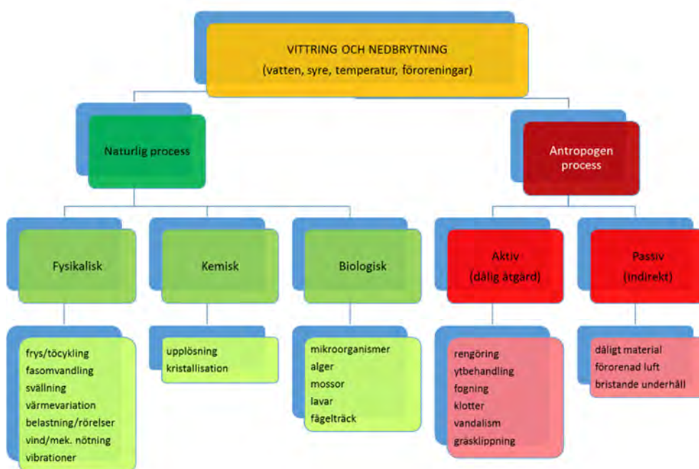
Figur 1 Nedbrytningsfaktorer för utomhussten. Hämtad från Friber och Sundnér Natursten i byggnader (1996).
