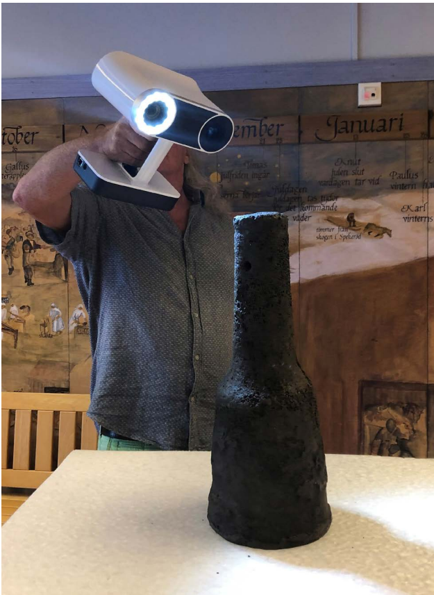
I projektet "Marstrandsbombarden", om ett fynd av en sk bombard, en lätt kanon bärgad år 2002 utanför Marstrand, har 3D-scanning genomförts. Bombarden står med mynningen ner och den smalare bakändan upp. Foto: Bohusläns museum.
