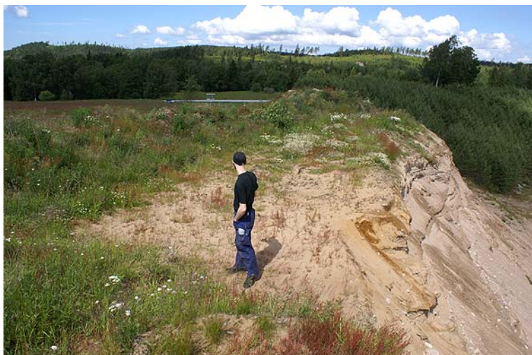
Tätkanten med bortschaktade kantvallar och matjord.
