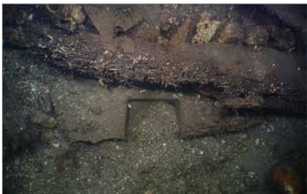
Figur 40. »Foder« med urtag för genomgående tvärbalk in situ (fnr 50). Foto mot sydost taget vid undersökningen 2008. Foto Staffan von Arbin, Bohusläns museum.
