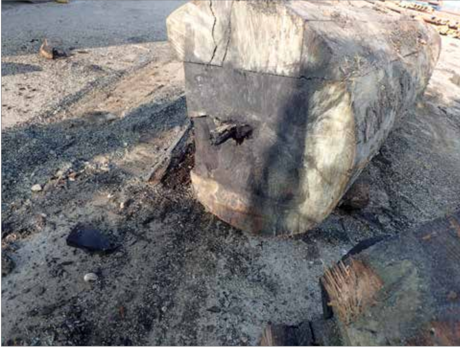
Figur 24. Tvärsnitt av masten 566. Här syns kärnan och de omkringliggande fodren som tillsammans utgör själva masten. Foto: Astrid Lennblad, Bohusläns museum.
