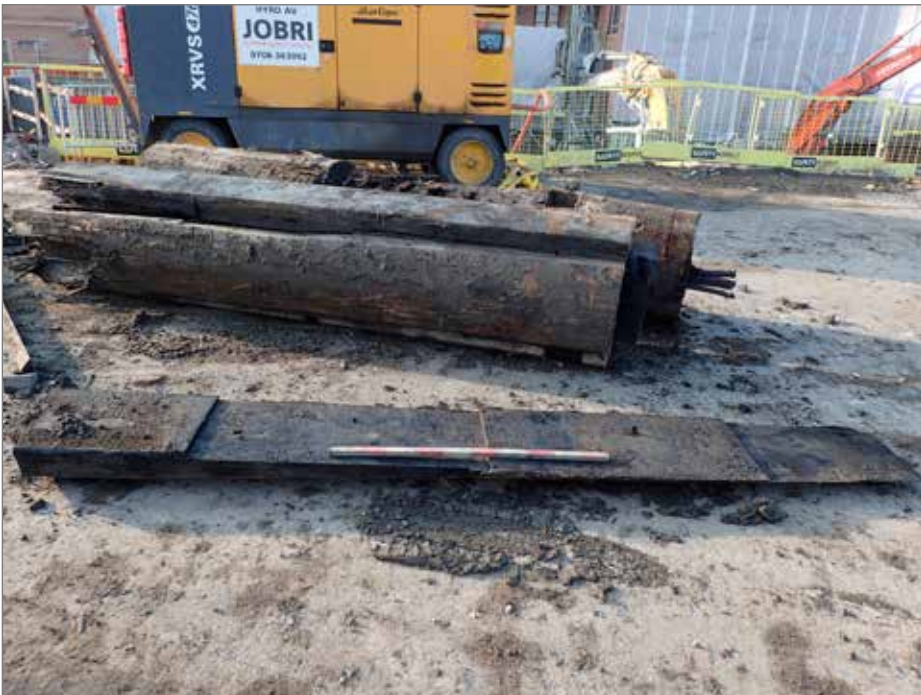
Figur 25. Mast 566 under isärplockning för dokumentation. På bilden syns en del av fodringen. De olika hacken som syns på fodret är där den har passats ihop med kärnan för att skapa en stabil mast. Foto: Astrid Lennblad, Bohusläns museum.
