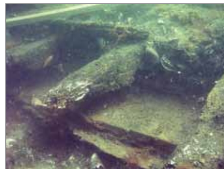
Figur 14. Provgrop 3 grävdes ned till innergarnering, spant och bordläggning. Notera skeppsmaskangreppen i spantens ovansidor. Foto: Jens Lindström, Bohusläns museum.
