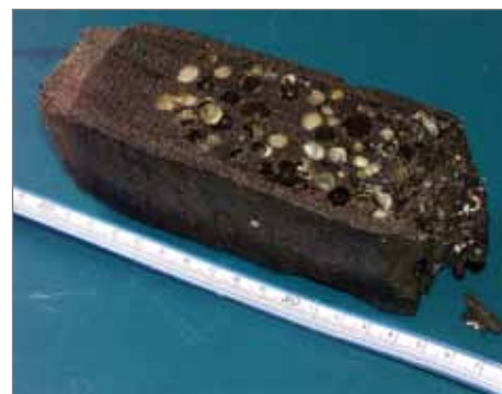
Figur 25. Prov på planklasten i provgrop 1 med kalkgångar efter Teredo navalis , den vanligaste skeppsmaskarten utmed Västkusten på djup ned till cirka 15 meter. Foto: Staffan von Arbin, Bohusläns museum.
