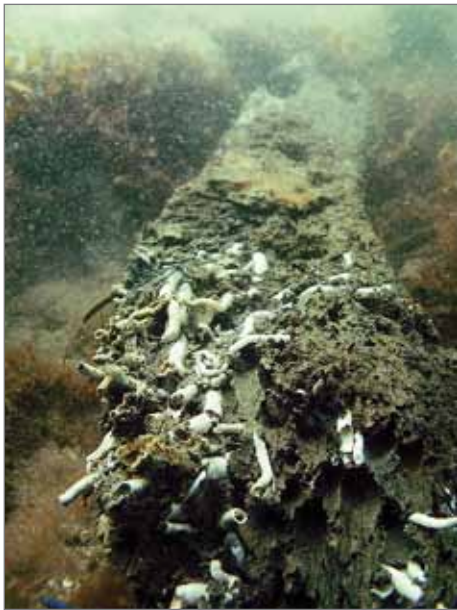
Figur 6. Exempel på timmer angripet av skeppsmask. Skeppsmasken, som namnet till trots är en mussla, borrar gångar i träet som den invändigt klär med kalk. Foto: Jens Lindström, Bohusläns museum.
