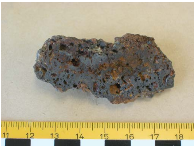
Figur 3. Den större slaggen från A300. Tvärsnitt.
