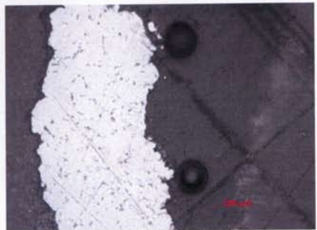
Figur 8. F94, mikroskop bilden visar ferritiskt järn (vitt) med sparsamt med perlit (mörkare fläckar).
