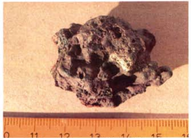
Figur 2. F49, en fluten omagnetisk slagg från A6. Notera den vitbrända vidhäftade leran
