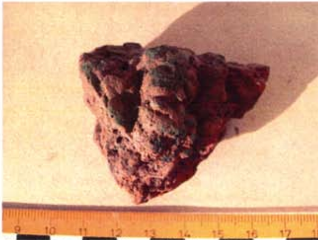
Figur 1. F29, slagg vilken troligen är en del av en smidesskälla
