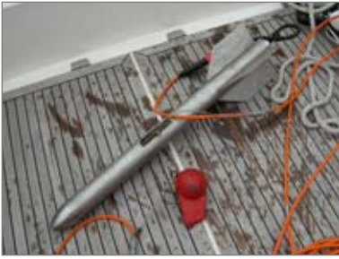
Figur 6. Den sidescan sonar som användes vid undersökningen. Foto: Staffan von Arbin, Bohusläns museum.
