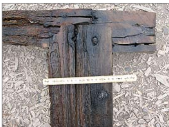
Figur 17. (nedan) Spant med vidhängande bordläggningsplanka från anläggning 2. Spantet är sammanfogat med bordläggningen med spik. Foto: Staffan von Arbin, Bohusläns museum.
