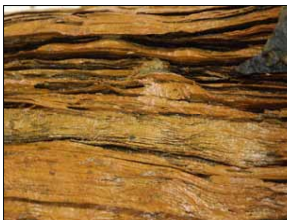
Fig. 3. Järnet är "trådigt" i sin struktur: Detalj.
