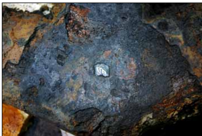
Fig. 4 Blyplätten avlägsnad, kvar en kärna i ett centralt hål. Hålet är inte genomgående.
