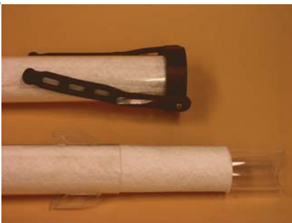
Bild 14 Skyddsroren fodrades med en tunn geotextil för att filtrera bort störande sediment. Rören applicerades vertikalt genom gruslagret för att mäta miljön i övergången mellan kulturlager och gruslager.
